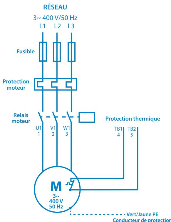
Raccordement de la protection thermique du bobinage:
