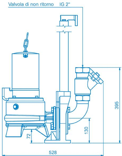
Posizionamento con anello di supporto a pavimento
